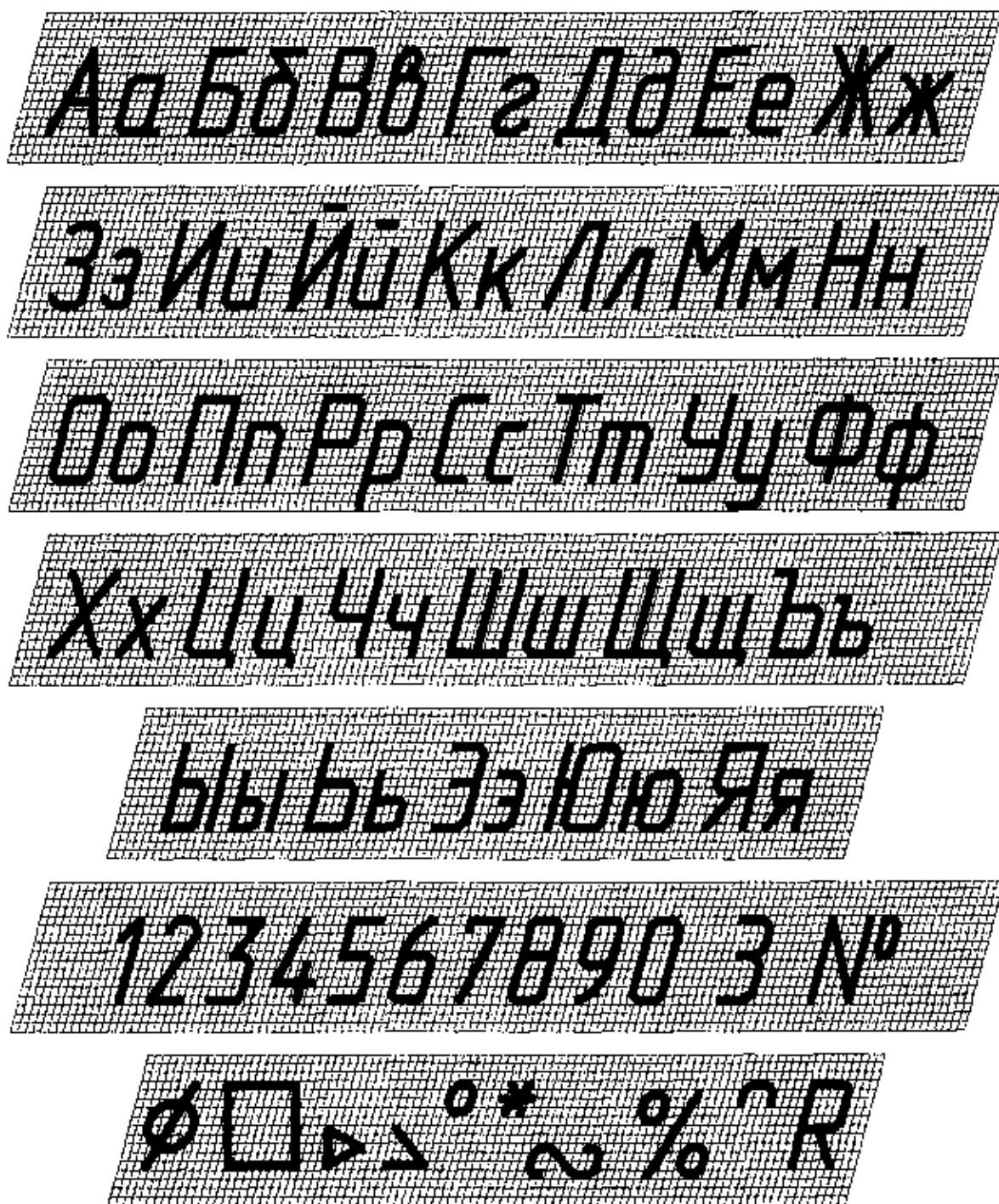
Рис. 1.6. Начертание и размеры букв русского алфавита, арабских цифр и СИМВОЛОВ
